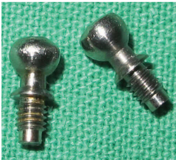
1. Ábra: Rendelkezésre álló alkatrészek a csavarmenet megállapításához
