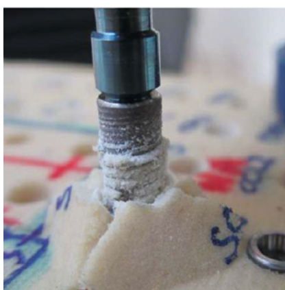
1-3. Ábra: Scandrea implantátum D1 anyagból való kitépése
