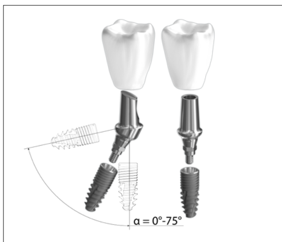
2. ábra: MC egyenes és szögöntött csiszolható felépítmények.
